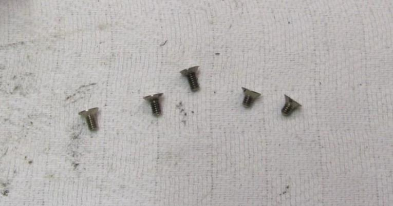
Hier werden nochmals die Schrauben gezeigt, welche die Schleifkappen und die Achslagerplatte halten. Die beiden kürzeren rechts sind für die Mittelschleiferkappe. Da diese bei der V36 genau über der mittleren Achse und der Blindwelle liegen, dürfen keine längeren eingedreht werden!!
