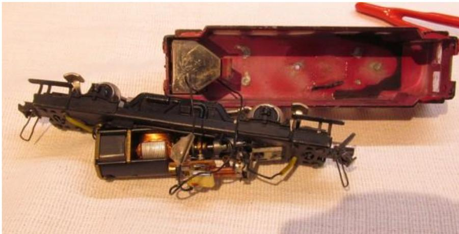
Die Kabel der Lampen, von den Schleifern und die Widerstände vom Motor ablöten
