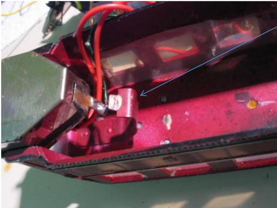
Die Lichtbox wird von einem Federblech auf der Rückseite im Gehäuse gehalten.
