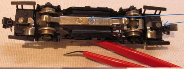
Wie bei anderen Modellen werden die Schleiferkappen durch Senkschrauben gehalten
