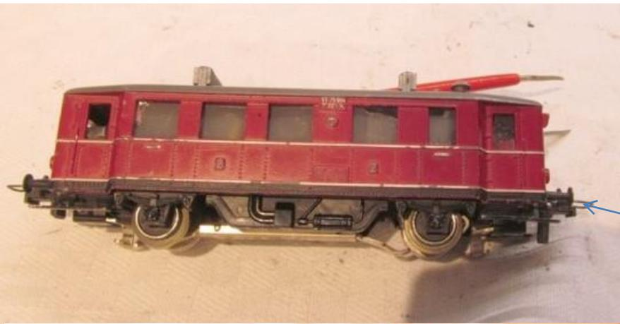
Das gute Stück ist auch an der Gehäuseoberfläche stark verschmutzt. Zur Reinigung kann man einen weichen Lappen und Wasser mit einem Schuß Spülmittel verwenden.
