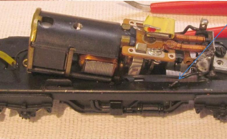
Der Mittelschleiferträger ist gleichzeitig die Attrappe des Unterflurmotors.
